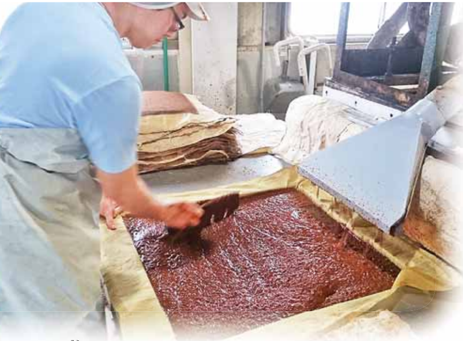
ろみ 濾布にもろみを流し込み、均等になるよう手作業でならす。こののち圧搾機で搾る
