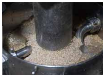
▲水洗い ごまについた砂やほこりを洗い落とす。水洗い後は遠心力を利用して適度な水分量になるまで脱水する
