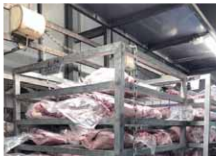
▲静電場解凍装置 静電気(静電圧)が鎖を通り、肉を解凍する。従来の流水解凍よりも短時間で解凍できるため、ドリップが出にくく、肉のうま味を保ちやすい
