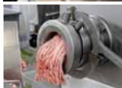
◀チョッピング 5mm以上のプレートで肉をひき、肉片の粒子が残るようにしている
